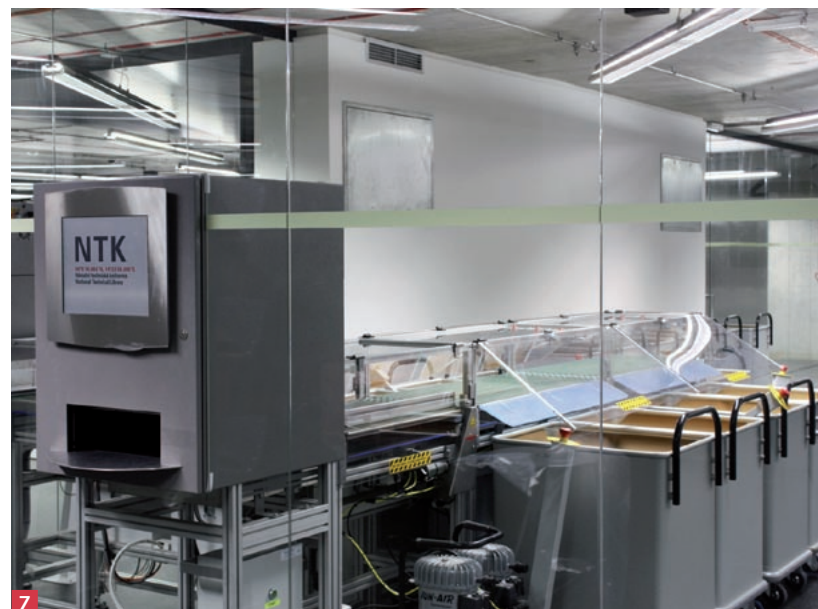
7 | samoobslužné zařízení na vrácení publikací s třídičkou
